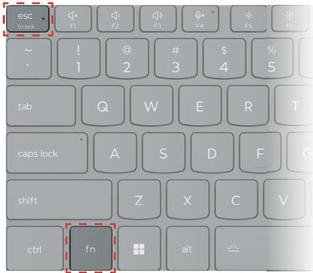
Abbildung 2. Positionen der Fn Lock-Taste und der fn-Taste
