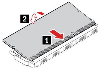
**Anmerkung:** Stellen Sie während der Installation sicher, dass Sie das Speichermodul am Steckplatz ausrichten. Drücken Sie es anschließend an beiden Seiten herunter, bis die Verriegelungen mit einem Klick eingerastet sind.
